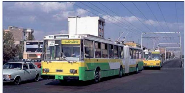
Fig. 28 - Ferrovie metropolitane e suburbane di Teheran. Dall'alto a sinistra, in senso orario: pianta della rete metropolitana; linea 3 della metropolitana; linea filoviaria 1, con filobus Škoda 15Tr (si notino i due bifilari, uno per le corse che fanno tutte le fermate e l'altro per le corse dirette - (foto S. VIGANO); ferrovia suburbana «Tehran-Karaj-Mehrshahr Express Line» (linea 5).
