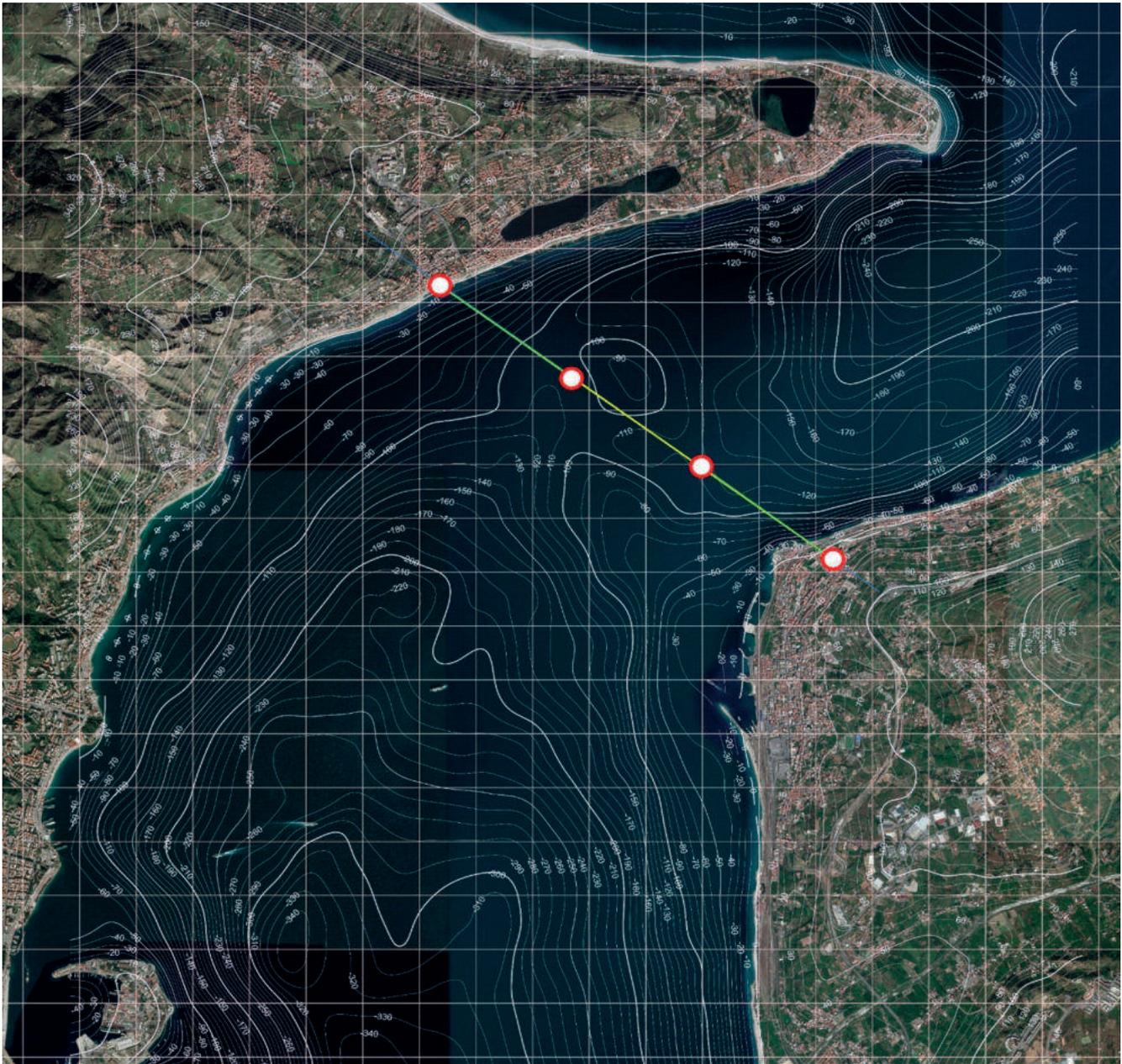
Figura 32 – Diretrice ipotizzata per il ponte sospeso multicampata [72][73].
