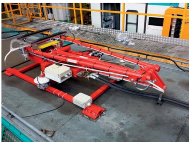
Fig. 3 - Installazione pantografo tipo JRC15 su locomotiva E464.430.
