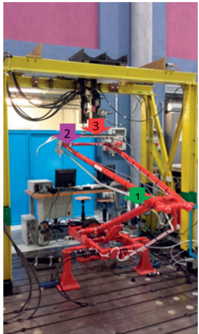
Fig. 8 - Punti di misura per il calcolo delle funzioni di trasferimento sperimentale.
