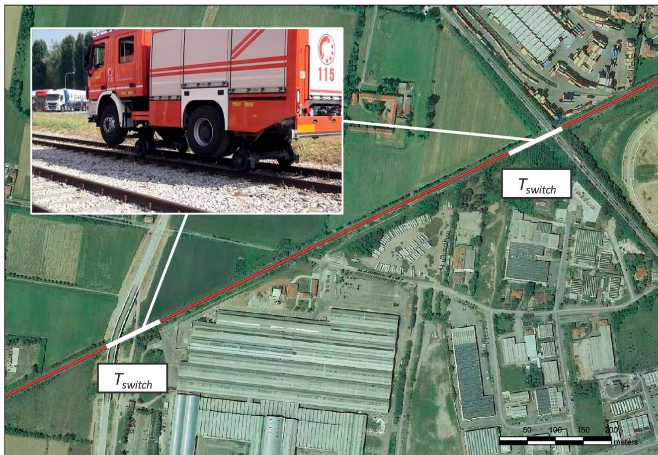
Fig. 12 - Esempio possibili accessi strada/ferrovia da realizzare (fase 2).
