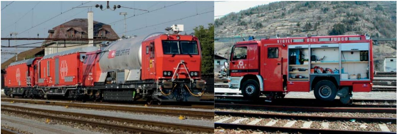
Fig. 2 - Veicolo antincendio ferroviario a sinistra (<http://m.ffs.ch>) e veicolo bimodale a destra (<http://www.vigilfuoco.it>).
