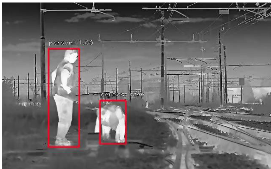
Figura 6 - Rilevazione ostacoli del sistema SCS. Figure 6 - Obstacle detection of the SCS system.
