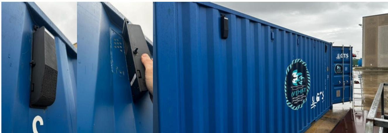
Figura 3 - Posizionamento del sensore durante la prova con un incendio reale.
