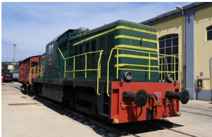
Figura 4 - Locomotiva diesel elettrica D143 "Truman", precedentemente Ne 120, giunta in Italia nel 1943 con le truppe alleate
