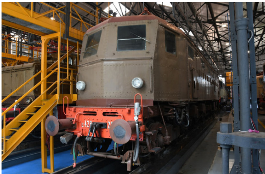
Figura 3 – Locomotiva E428 con cassa semiaerodinamica nell'area manutenzione.
