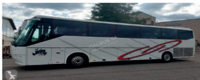
Pullman da turismo Bova Futura con motore Man (400 CV), peso in ordine di marcia 12 t, passeggeri seduti 57
