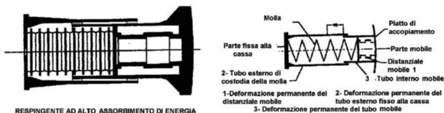
Figura 5 – Respingente ad alto assorbimento di energia.
