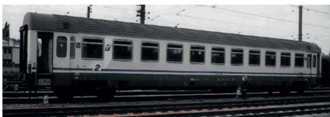
Carrozza di seconda classe UIC Z - peso in ordine, di marcia 43 t, passeggeri seduti 66
