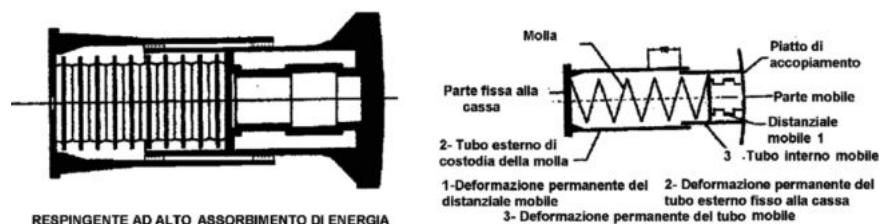
Figura 5 – Respingente ad alto assorbimento di energia.
