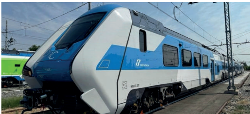
Figura 4 – Autorizzato il primo elettrotreno ibrido con trazione bimodale, elettrica da catenaria a 3 kv cc e batterie.
