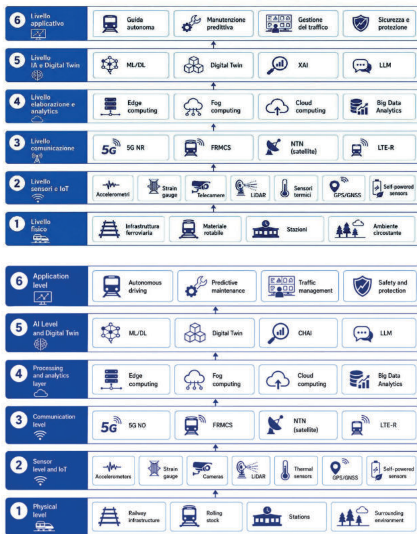
Figura 7 — Ecosistema tecnologico per il trasporto ferroviario intelligente (basato su [15][19][20][22]).
