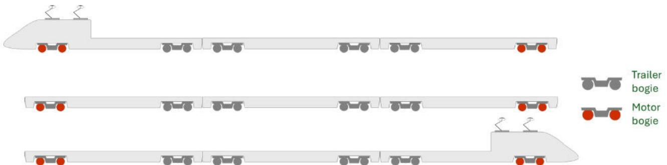
Figura 5 - Esempio di composizione di un F-EMU con modulo elementare formato da 3 carri a composizione bloccata e con le unità di testa e coda.
