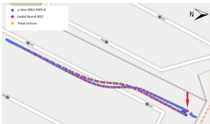
Figura 8 - Soluzione grafica del test n.8 di validazione del sistema GNSS in ambiente urbano.
