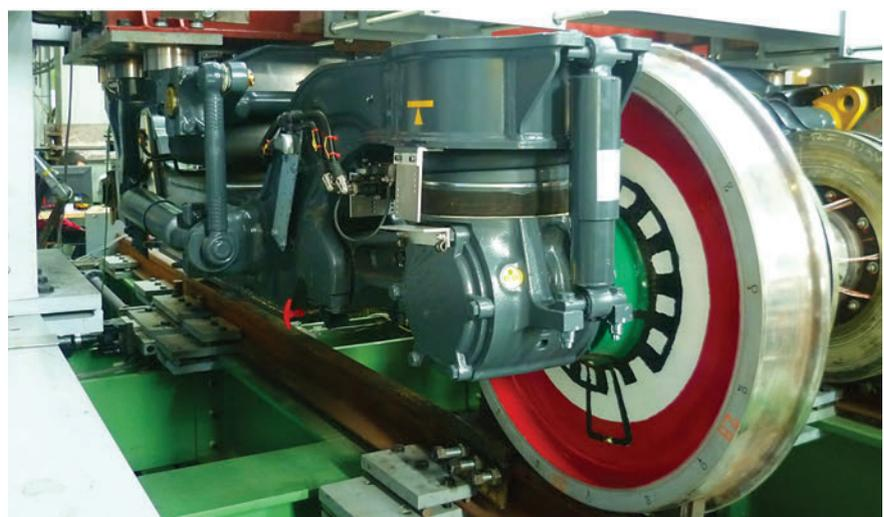
Figura 8 - Installazione sistemi di misura: rotaia strumentata (figura in alto) e sala strumentata (figura in basso).
