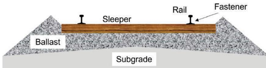
Figura 1 - Componenti principali che costituiscono l'armamento ferroviario.
