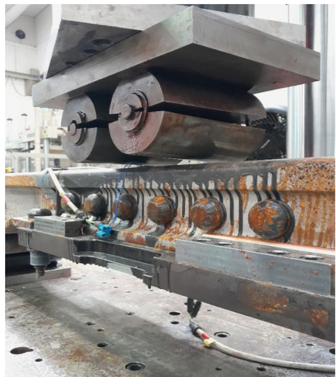
Figura 12 - Uno dei primi prototipi del giunto ABJ sottoposto a prova di flessione ancora nella versione con i "traversini" (successivamente rimossi).
