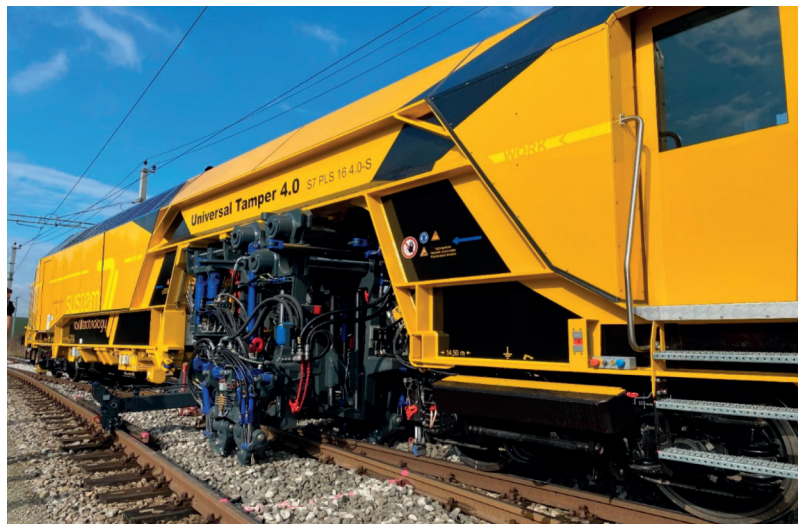
Figura 4 – Robot di rincalzatura 4.0 al lavoro per la rincalzatura di un deviatoio.
