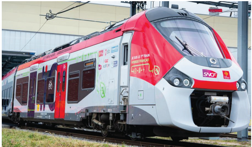
Figura 1 – Il primo treno regionale francese a utilizzare le batterie per la trazione. Figure 1 – France’s first regional train to use batteries for propulsion.
