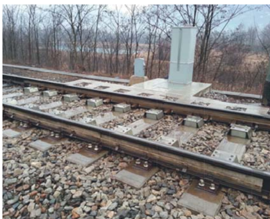
Fig. 32 - Rotaie strumentate e armadio contenente i dispositivi UAD e SATR.
