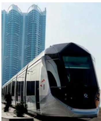
Fig. 2 – Il tram di Alstom senza catenaria per Dubai.
