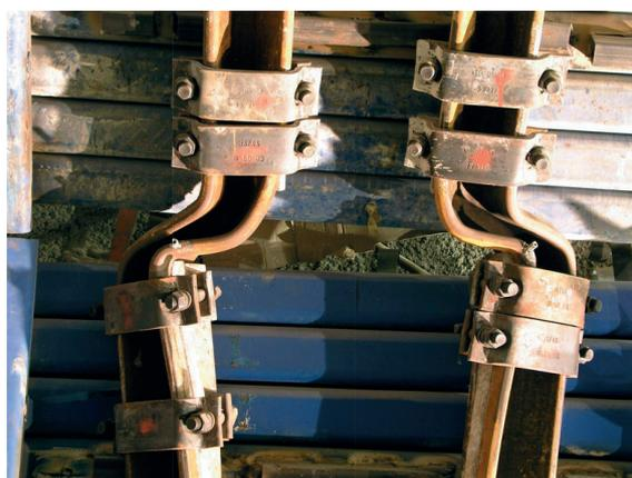
Fig. 7 – Archi di acciaio caricati fino alla deformazione permanente delle centine (TH44). *Steel arches loaded up to local buckling of the ribs (TH44).*
