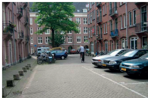
Fig. 2 - Un Woonerf con parcheggi perpendicolari alla carreggiata, pensati per limitare la velocità lungo la strada.
