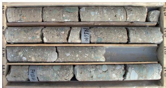
Fig. 33 - Campioni prelevati con carotiere T6S con diametro da 131 mm.
