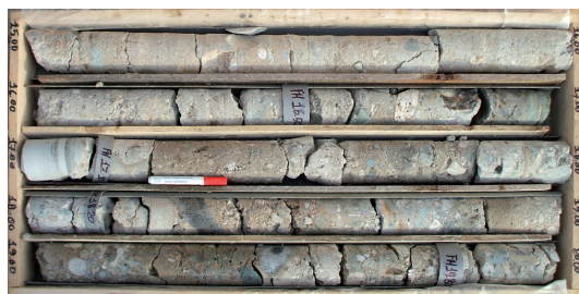
Fig. 34 - Campioni prelevati con carotiere T6S con diametro da 101 mm.
