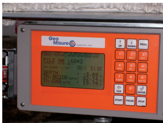
Fig. 32 - Dettaglio schermata sistema di registrazione dati di perforazione e iniezione.
