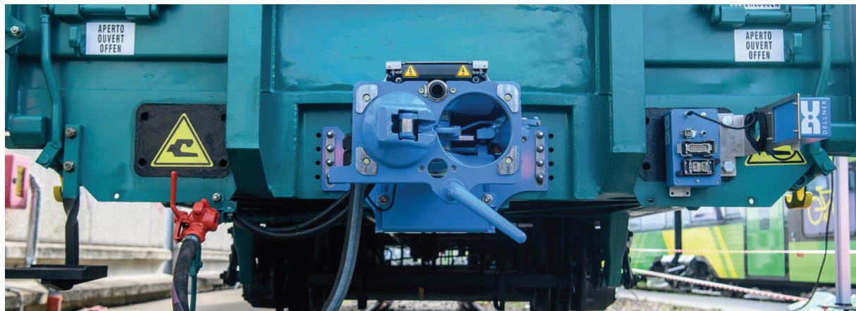
Figura 5 – Il nuovo DAC esposto a Expo Ferroviaria 2025 nell'ambito delle nuove tecnologie per l'innovazione della logistica in Europa.
