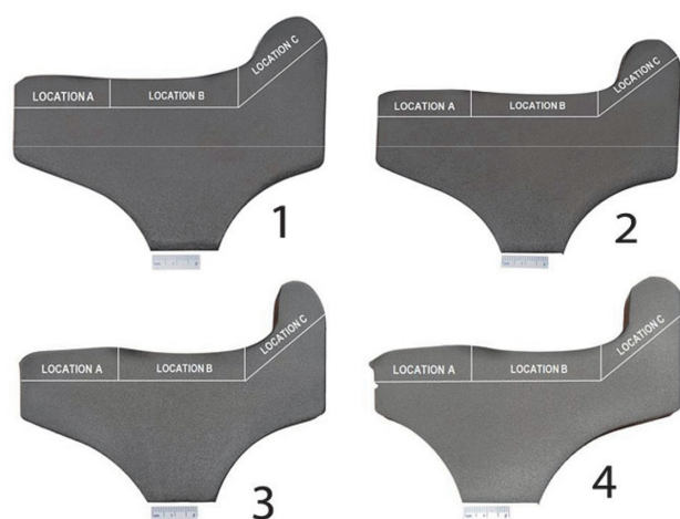
Fig. 1 - Sezione delle quattro ruote usurate esaminate. La “gola di usura” compare su tutte le quattro ruote esaminate; le ruote 3 e 4 presentano anche un “tread roll over” intenso.
