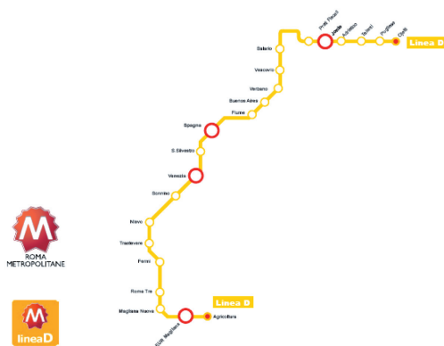
(Fonte RomaMetropolitane) Fig. 2 - Schema della costruenda linea D della metropolitana di Roma.
