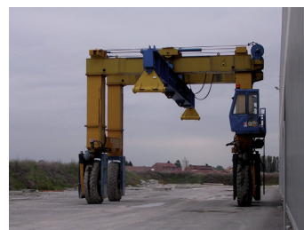
Fig. 8 - Carrellone per il trasporto travi prefabbricate.
