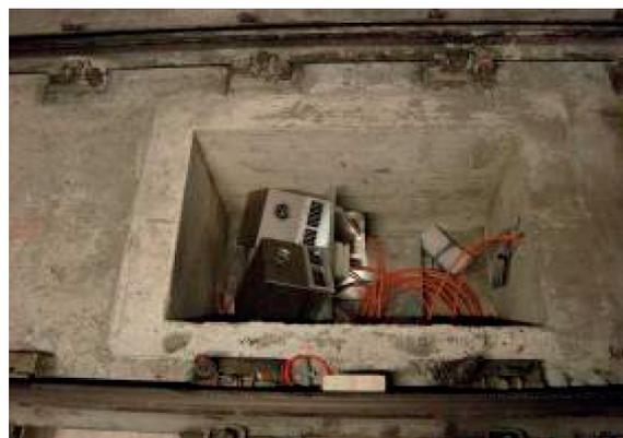
Fig. 6 - Modulo Termografico: IRS 350-2.
