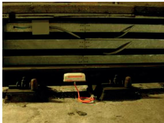
Fig. 4 - Modulo Riconoscimento Rotabili: sensori di ruota.
