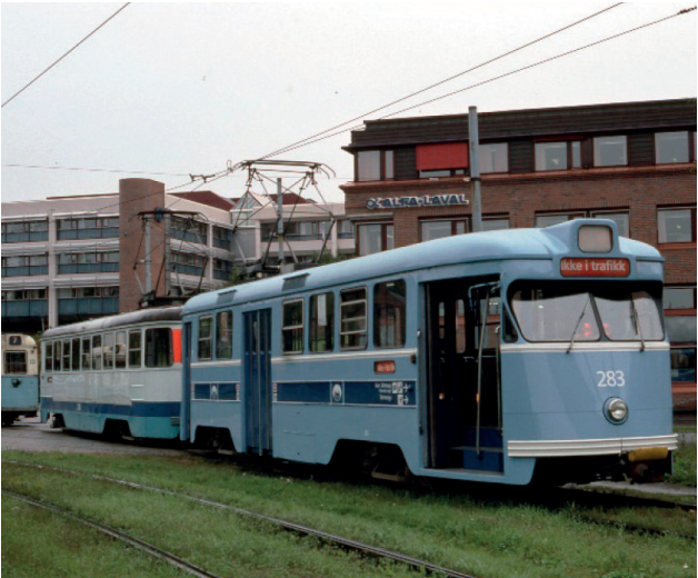
Figura 6 – Convoglio di due unità ex Göteborg rivolte in versi opposti. Figure 6 – Convoy of two traction units ex Gothenbourg connected in opposite directions.
