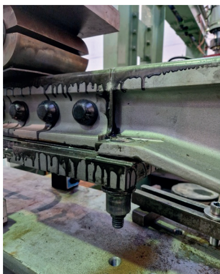
Figura 16 - Rottura di uno dei chiodi verticali e scollamento del coprigiunto durante la prova di flessione del giunto ABJ_009 (sinistra). Deflessioni prima (tre cicli simili, spostamento circa 2 mm) e dopo la rottura del chiodo (cicli singolo, spostamento circa 4 mm) (destra).
