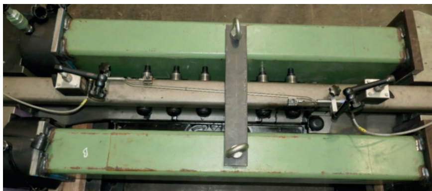
Figura 14 - Prova di trazione sul giunto ABJ_007. Due trasduttori di spostamento sono posizionati per la misura dell'allungamento residuo al termine della prova che è definito nelle varie normative.
