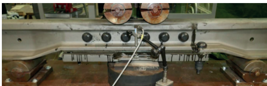
Figura 15 - Prova di flessione sul giunto ABJ_009. Un trasduttore di spostamento è posizionato per monitorare l'abbassamento verticale del giunto durante l'intero arco della prova.
