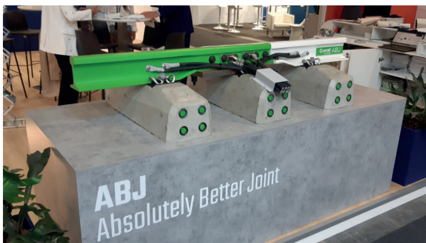
Figura 6 - Il nuovo giunto ABJ in esposizione alla fiera INNOTRANS 2024 di Berlino. Sono ben visibili i collegamenti elettrici che usano come conduttori i chiodi Huck e che permettono di eliminare completamente i cavi poggiati sul ballast e la necessità di traverse cave.
