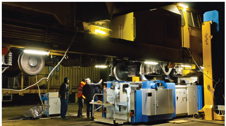
Fig. 2 - Alcuni aspetti tecnici ed operativi nell'uso del tornio mobile.
