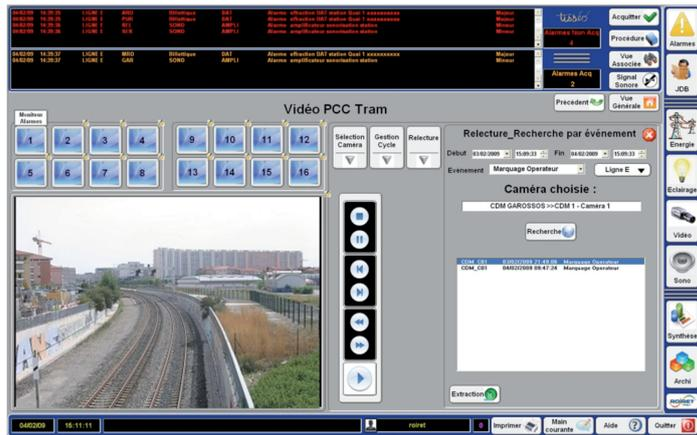
Fig. 6 – Gestione della funzione di monitoraggio in tempo reale del traffico tramviario: ausilio della visualizzazione per mezzo di telecamere.
