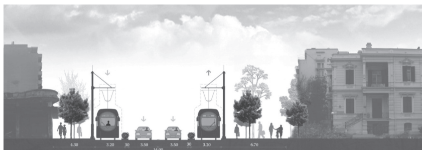
Figura 3 – Posizionamento di un unico binario tranviario sui due lati opposti della carreggiata [2].
