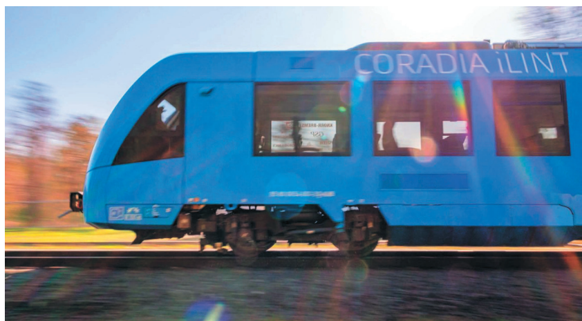
Figura 4 – Il treno a idrogeno Coradia iLint di Alstom durante una corsa prova. Figure 4 – Alstom's Coradia iLint hydrogen train during a test run.
