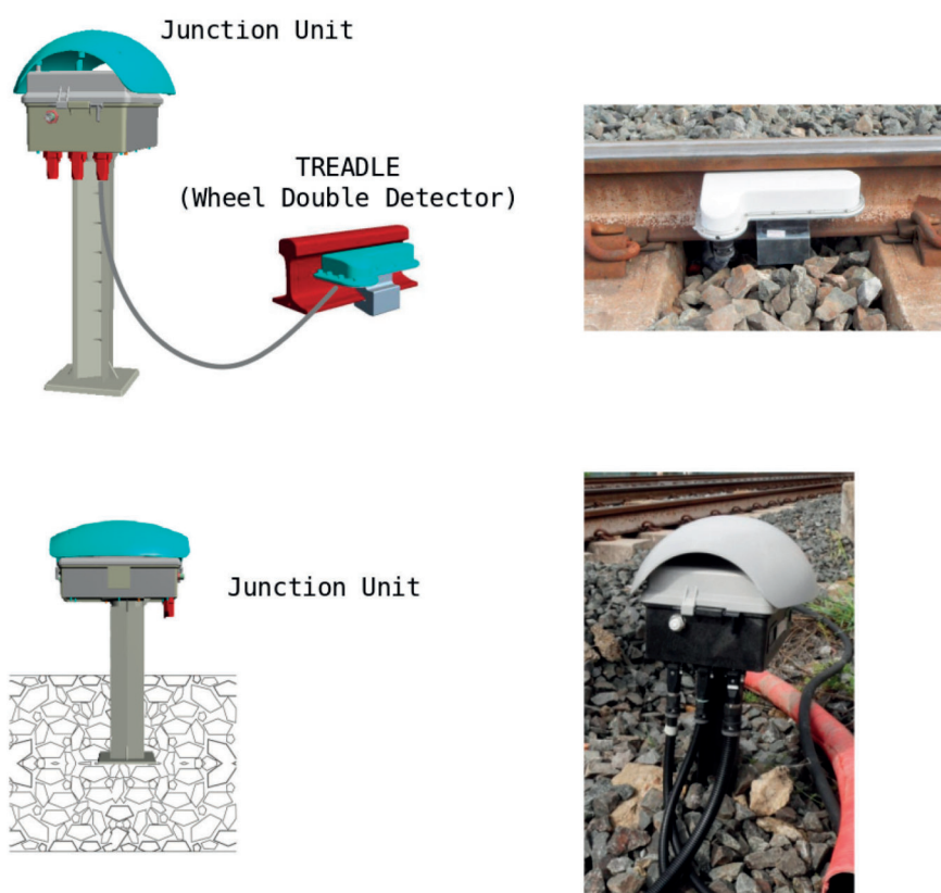
Figura 1 – Architettura Hardware del pedale elettromagnetico installato sulla linea.
