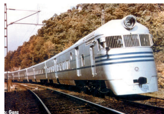
Fig. 19 - Il treno elettro-diesel Ganz. Da notare la robusta protezione dei finestrini della cabina di guida, comunemente adottata su molti treni argentini, probabilmente per prevenire danni in caso di investimento del bestiame vagante.
