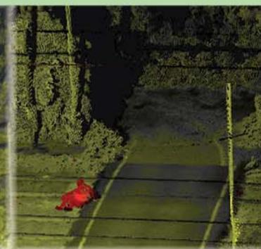
riconoscimento posizione/dimensioni degli ostacoli e ricostruzione 3D
