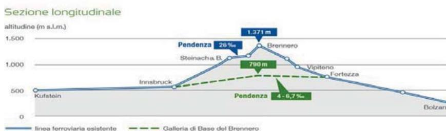
Fig. 11 - Le caratteristiche altimetriche del Tunnel di Base del Brennero.
