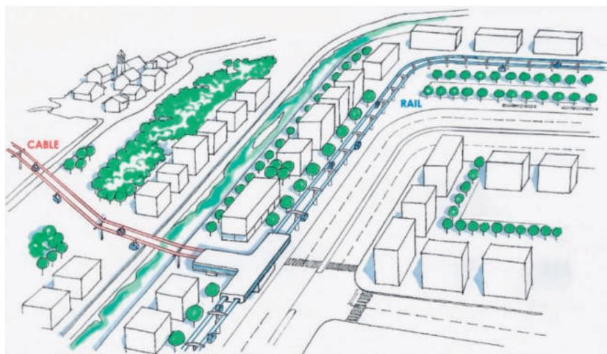
Fig. 1 - Bozzetto rappresentante le due modalità di funzionamento del sistema (CableSmart). In rosso è rappresentato il segmento in fune, in blu la tratta in rotaia.
