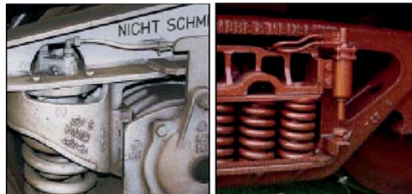
Fig. 15 - Esempio di cella di carico, a sinistra, e valvola elettro-pneumatica, a destra, per la rilevazione del carico del veicolo. Example of a load cell (LH) and electro-pneumatic valve (RH) to detect the load of the vehicle.
