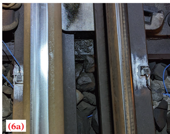
Figura 6 – Accelerometri (6a) e sensori laser (6b) installati per il monitoraggio. Figure 6 – Accelerometers (6a) and laser sensors (6b) installed for monitoring.
