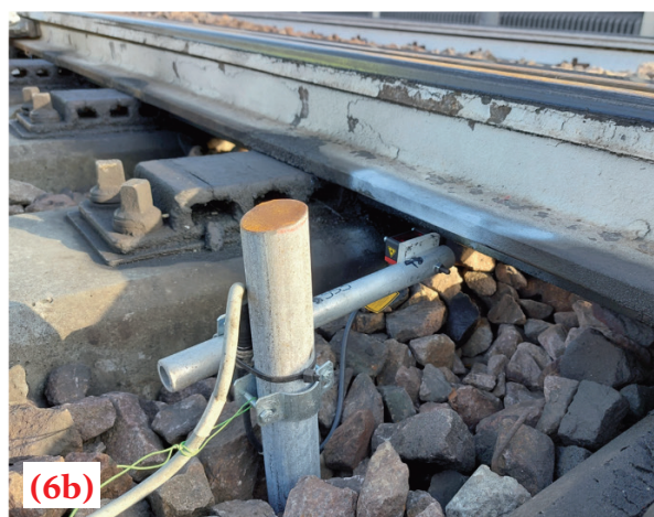
Figura 6 – Accelerometri (6a) e sensori laser (6b) installati per il monitoraggio. Figure 6 – Accelerometers (6a) and laser sensors (6b) installed for monitoring.
