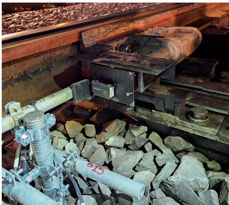
Figura 5 – Sensori laser per il monitoraggio degli spostamenti in punta Figure 5 – Laser sensors for monitoring point movements.
