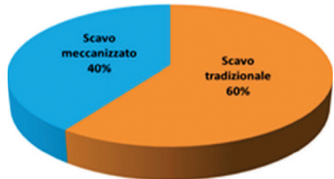
Fig. 6 - Ripartizione tra scavo tradizionale e scavo meccanizzato.
