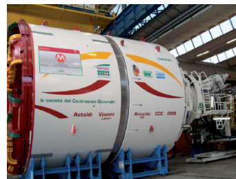
(Fonte RomaMetropolitane) Fig. 2 - La TBM per lo scavo della linea C della metropolitana di Roma.
