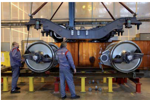
Fig. 2 - Una fase dell'assemblaggio del carrello di un AGV di Alstom.
